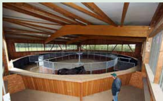
Die Seiten geschlossen, die „Abteile“ voneinander getrennt – so sieht eine wünschenswerte Führmaschinenkonstruktion aus. Foto: Frank Sorge
